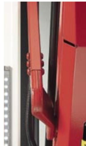
7. Il monobraccio di sostegno e di movimentazione della parte mobile, brevetto Ballan, è stato opportunamente sagomato per rispettare gli spazi di sicurezza ed evitare il cesoimento delle dita.
