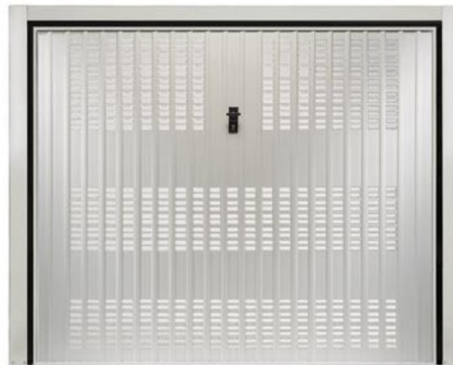
8. Porta basculante Logika, con massima foratura dell'anta mobile (fori di ventilazione 60x20 mm). Vista esterna basculante L 260 x H 220 cm. Mano di fondo Ral 9018.
