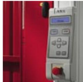
6. Il quadro comandi del sistema di controllo ASK, brevetto Ballan, è dotato di tastiera e display. Visualizza le funzioni della porta, la richiesta di manutenzione e permette la personalizzazione da parte dell'utente.
