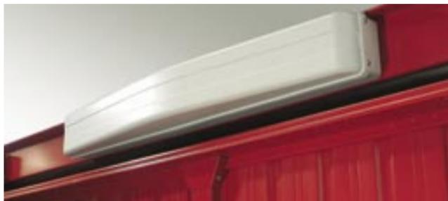
2. La centralina del sistema di controllo ASK, brevetto Ballan, è posta sulla traversa superiore e vigila in ogni istante sul funzionamento e sulla sicurezza della porta. La batteria tampone, inserita nella centralina, assicura la riserva di energia per il funzionamento d'emergenza in caso di black-out elettrico.
