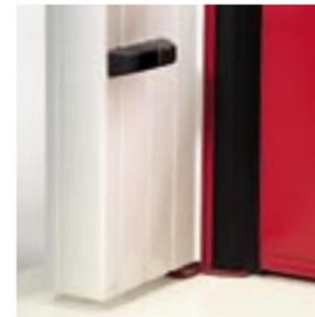
9. I rilevatori di presenza, applicati alle foderine copripeso e posti a 200 mm dall'anta mobile, bloccano istantaneamente il funzionamento della porta al passaggio di persone o cose.
